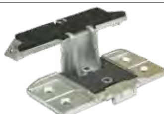
dla podpory 82 mm nr art. 840178020 z odlewu cynkowego z uszczelką EPDM alternatywa dla systemu nr 178020
