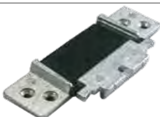
dla podpory 102 mm nr art. 840218525 z odlewu cynkowego z uszczelką EPDM i bolcami alternatywa dla systemu nr 212 030
